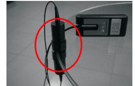
a : positionner un des lecteurs à l'emplacement choisi sur une des faces du vitrage à contrôler.
